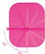
左右の手すり角度60~30°まで30°ピッチで調整可能(9段階)
